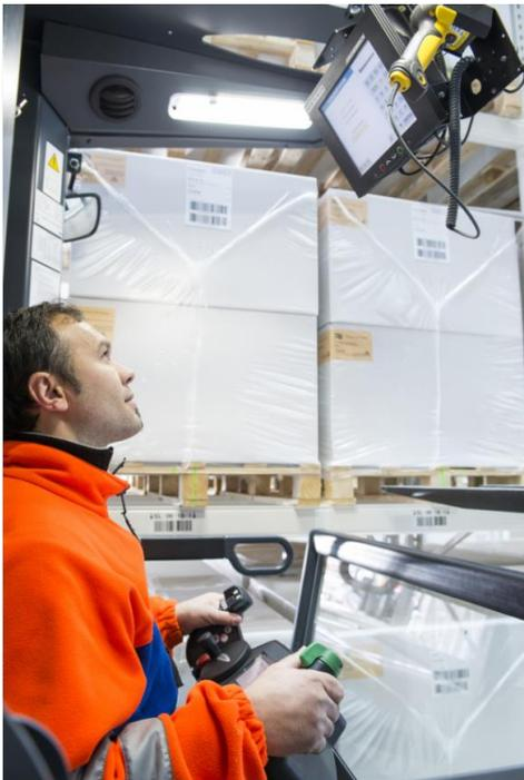
Abbildung 8: Lagernavigation empfängt Einlagerauftrag vom Jungheinrich WMS
