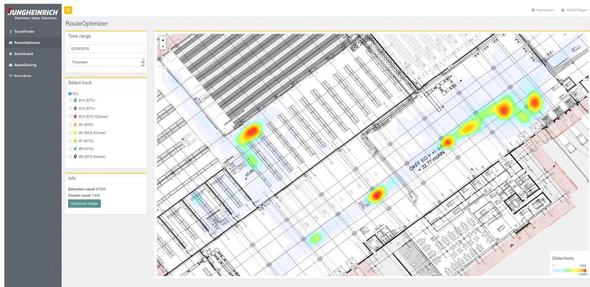
Abbildung 4: Visualisierung der Bewegung der Fahrzeuge im Lager, Modul RouteOptimizer. Anhand einer Heatmap ist zu erkennen, wo besonders viele Stapler fahren und somit Potential zur Optimierung der Transportwege besteht.
