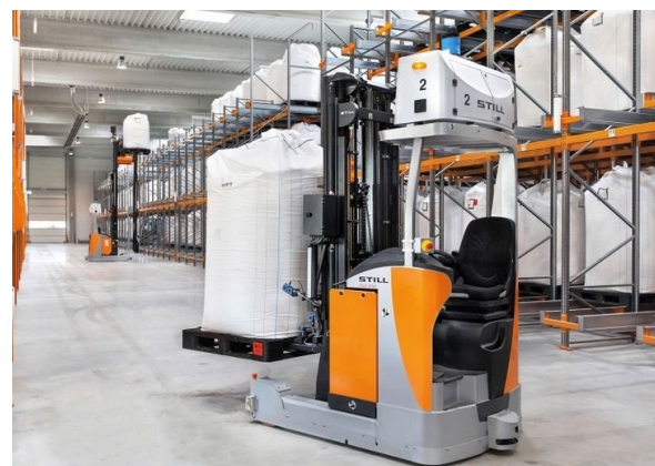
Automatisch transportieren die FM-X die Big Bags zur Fördertechnik der Arbeitsbühne.
