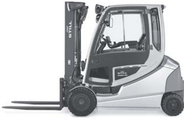
Vollkabine für Außeneinsätze bei jedem Wetter
