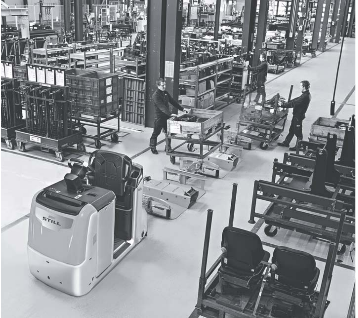
Höchste Flexibilität durch wechselseitige Be- und Entlademöglichkeit in schmalen Arbeitsgängen mit B-Rahmen
