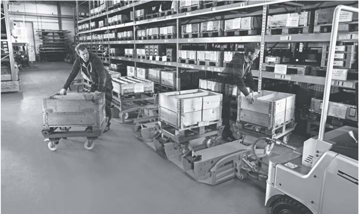
Mit B-Rahmen können unterschiedliche Ladungsträger transportiert werden
