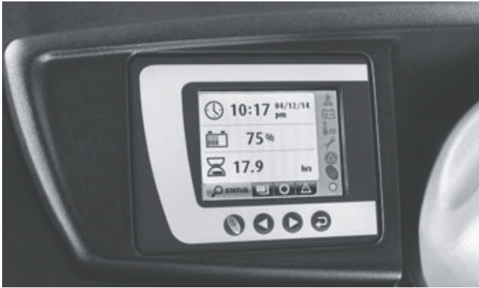
Immer alles im Blick: Farbdisplay mit vielen sprachunabhängigen Symbolen zeigt alle wichtigen Funktionen auf einen Blick
