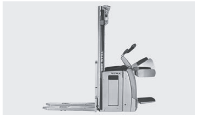
Jederzeit sicherer Stand: Dank der seitlichen verstellbaren Schutzarme immer sicher unterwegs
