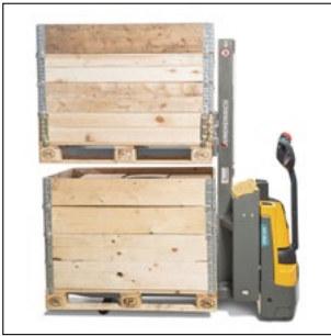
Doppelstockeinsatz - Aufnahme von zwei Paletten übereinander
